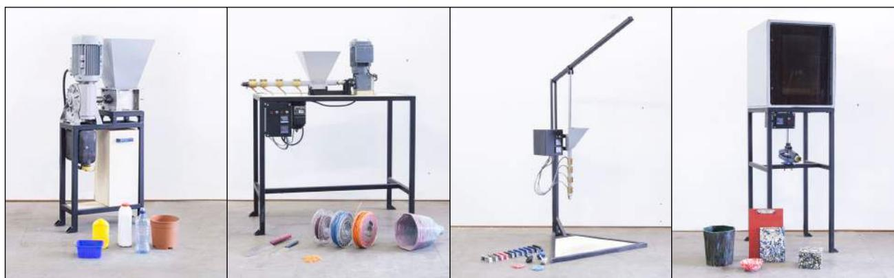
Precious Plastic Maschinen: „Shredder“, „Extrusion“, „Injection“ und „Compression“. *Quelle: Precious Plastic (2019)*
